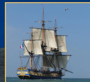
Frégate de 1166 tonnes, longue de 66 m, large de 11,5 m et de 5,78 de creux. Elle pouvait embarquer 316 hommes. Elle comptait trois mâts et sa voilure couvrait plus de 2200 m<sup>2</sup>. Elle comptait 34 canons, dont 26 tirant des boulets de 12 livres (d'où le terme de «frégate de 12»), et 8 canons de 8 livres.
